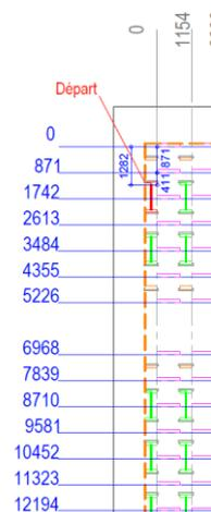
d. Répéter la méthode de traçage en ligne et en colonne. L'intersection des droites matérialise la position de chacun des rails iNova<sup>R</sup> bas 750.
